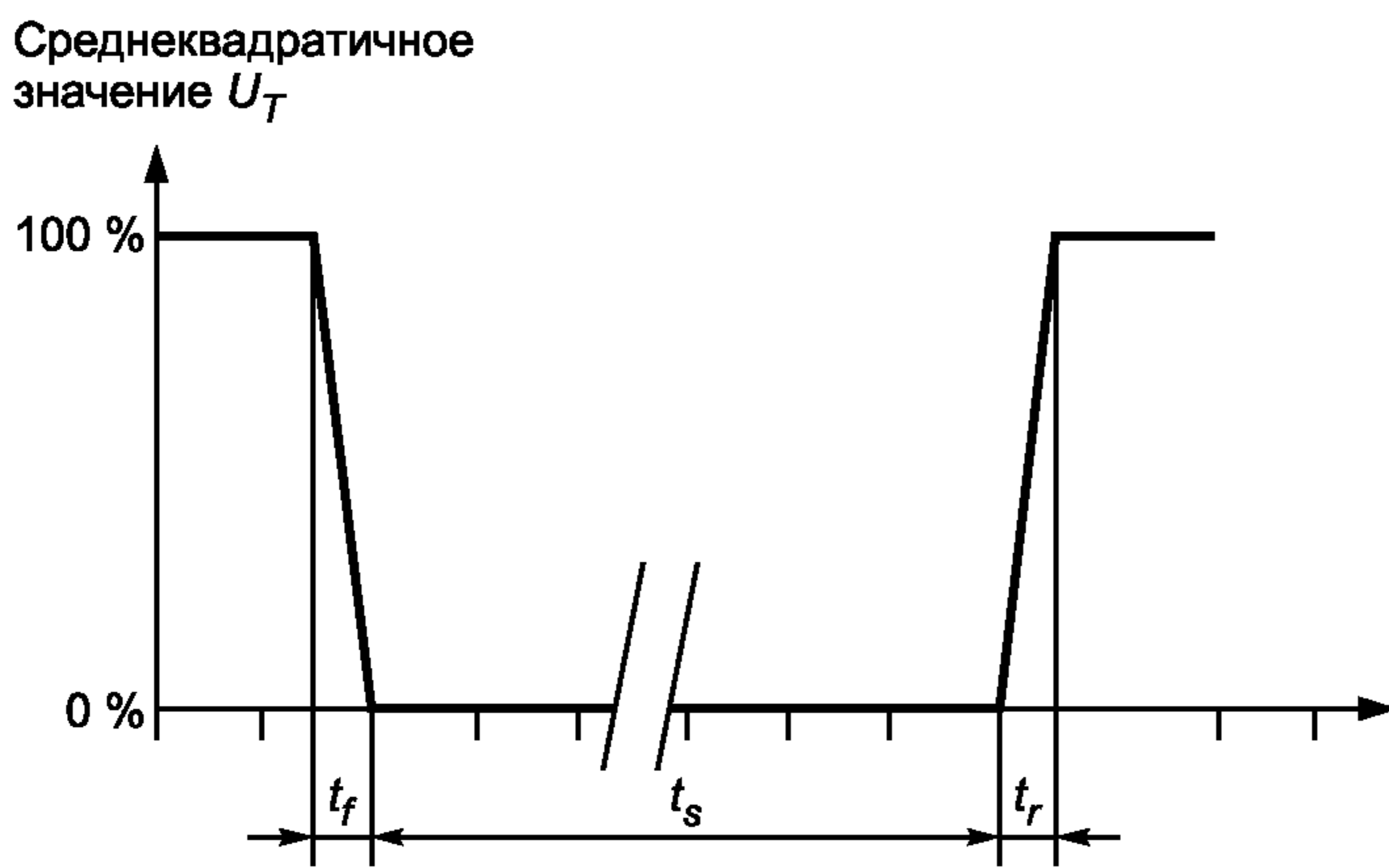
t_r — время нарастания напряжения; t_f — время понижения напряжения; t_s — время выдержки на пониженном напряжении
