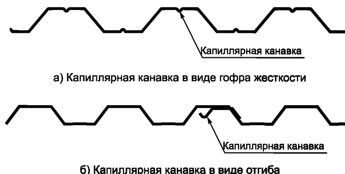
Рисунок 3 — Основные виды капиллярных канавок
